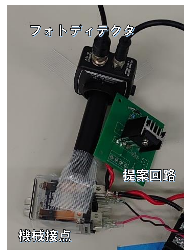
図6 アーク放電発光強度の定量評価実験装置の外観
