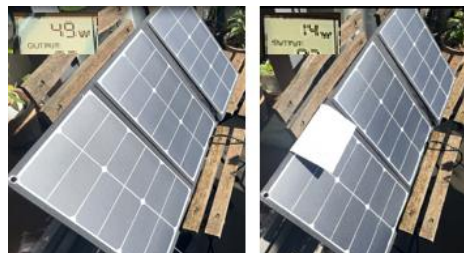
図 1 影での太陽光発電電力低下 (左)影なし(右)約 5%影で 70%低下
